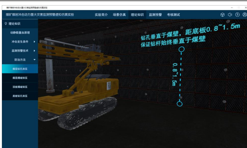
图 3.15 煤层钻孔卸压
