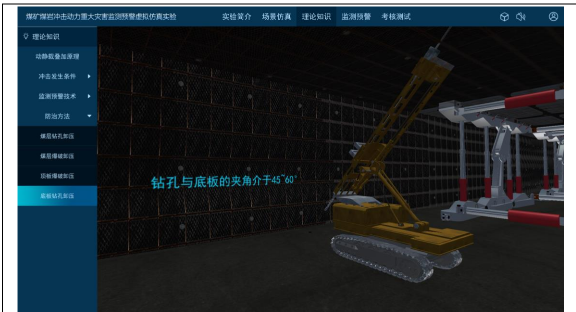
图 3.18 底板钻孔卸压
